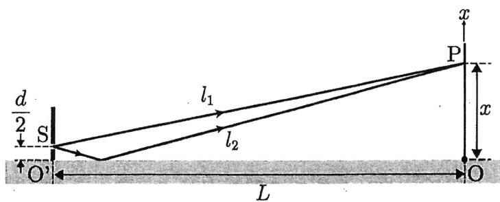
(1) スクリーン上のある点  $P$  に対して、 $OP$  間の距離を  $x$  ( $x \ll L$ ) とする。点  $S$  から点  $P$  に直接届いた光(直接光)の経路長を  $l_1$  と置くと、
