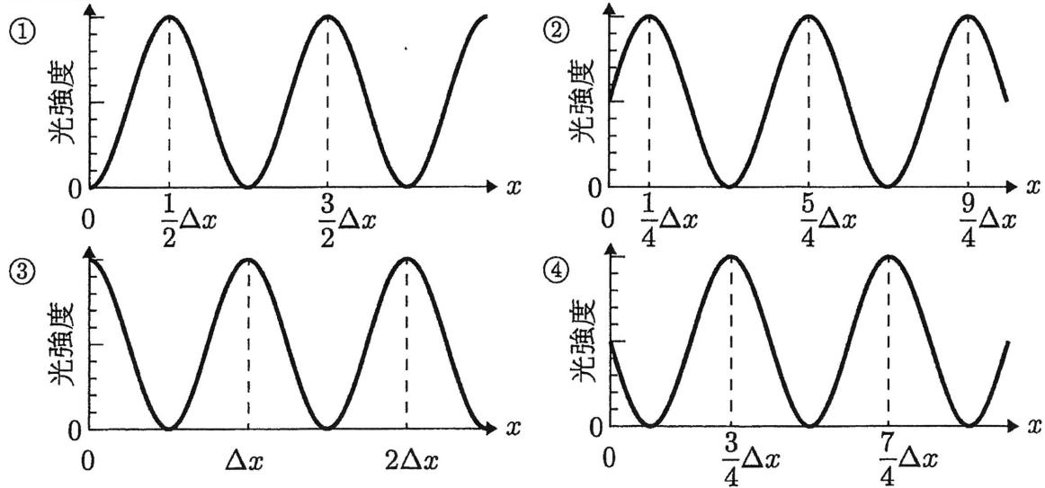
(5) 鏡 O'O からの反射光の電場の振幅が、直接光の振幅に比べて半分になったとする。このとき、観測される光強度をグラフにすると 49 となる。必要であれば  $2 \sin \alpha \sin \beta = \cos(\alpha - \beta) - \cos(\alpha + \beta)$ , ならびに  $\cos(\gamma t)$  ( $\gamma$  は任意の定数) の時間平均が 0 となることを用いてもよい。
